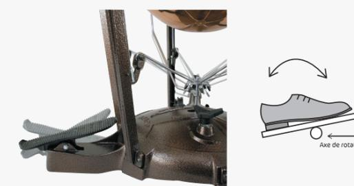
L'accord s'obtient par rotation de la pédale, qui est maintenue par un système de compensation mécanique.
